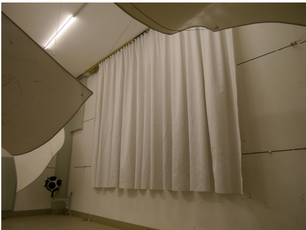
Abbildung C.2. Geraffte Prüfanordnung im Hallraum (Schrägansicht).
